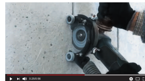
Аэродинамическая насадка штроборез AirCHASER. Удаление пыли для ВАШЕЙ углошлифовальной машины.
